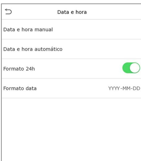
1. O produto suporta o sistema de sincronização de horário NTP por padrão. Essa função entra em vigor depois que a **sincronização automática de data e hora** é ativada e o link do endereço do servidor NTP correspondente é definido.
